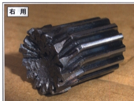
Fig A.8: モータ軸破損状況
