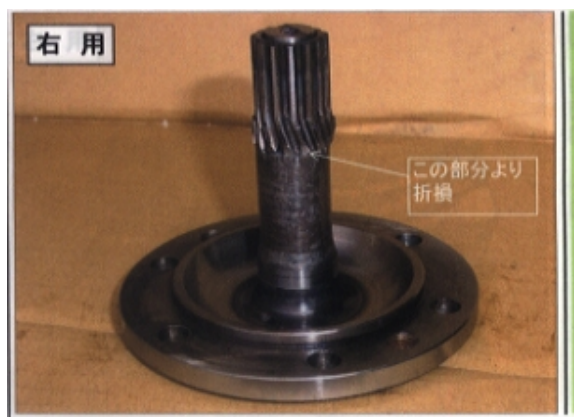
Fig A.7: モータ軸破損状況
