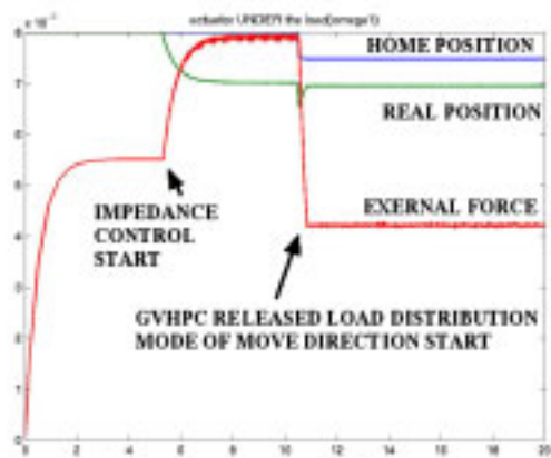
Fig.6.20: Fig.6.16 の領域 \Omega_2 におけるアクチュエータの時間応答 (力の角度 \frac{\pi}{4} )
