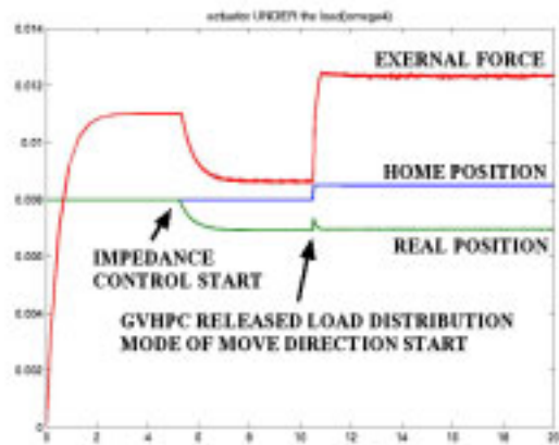
Fig.6.21: Fig.6.16 の領域 \Omega_4 におけるアクチュエータの時間応答 (力の角度 \frac{\pi}{4} )
