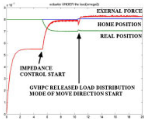
Fig.6.20: Fig.6.16 の領域 \Omega_2 におけるアクチュエータの時間応答 (力の角度 \frac{\pi}{4} )
