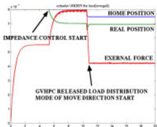
Fig.6.27: Fig.6.16 の領域 \Omega_2 におけるアクチュエータの時間応答 (力の角度 -\frac{\pi}{4} )
