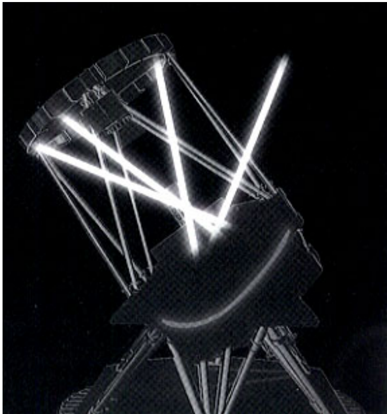
Fig.1.6: 反射鏡の歪みにより、光が集光できず乱されている様子
