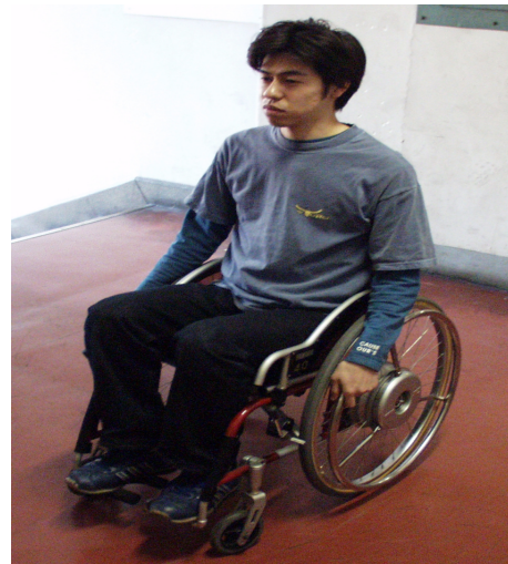
図 12: JW II を装着した車椅子
