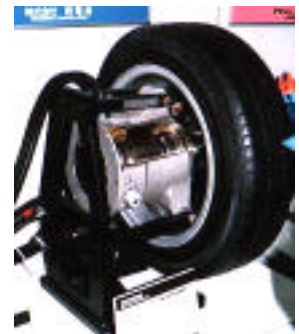
付図3 製作中の東大三月号(2号車, 4輪独立駆動車)と駆動用モータ
