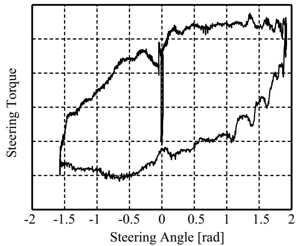
図 4.5: 市販 EPS での実験結果
