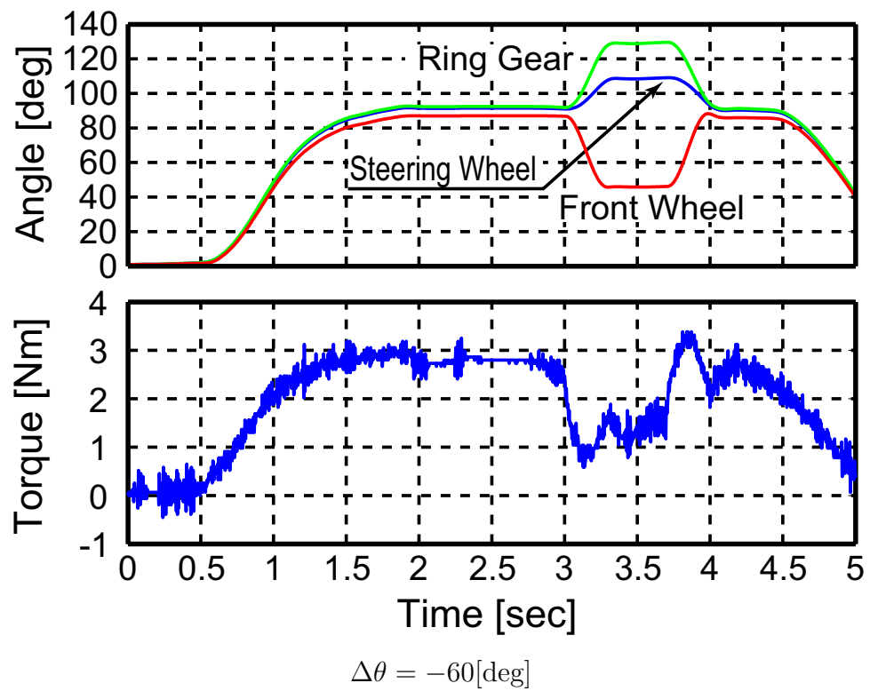
図 4.8: アクティブ操舵制御を模擬した実験
