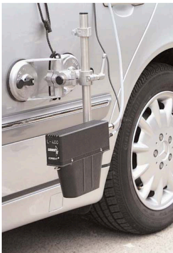
(a) 光学式速度センサ（空間フィルタ型）
