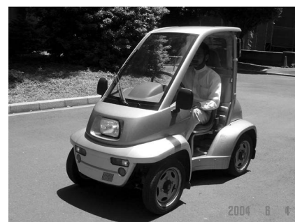
図 29 キャパシタだけで駆動するコムス CV
