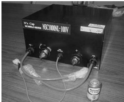
図 31 電気二重層キャパシタの一例 (100V, 25F)
