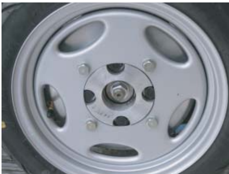
Fig. A.10: PCD チェンジャー装着時写真
