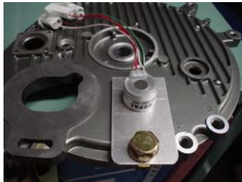
図 4.3: エンコーダの取り付け 図 4.4: エンコーダの周辺回路 図 4.5: ジャイロセンサの装着
