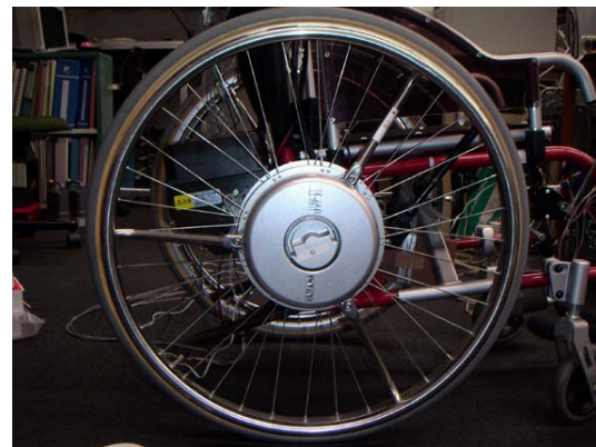
図 4.2: JWII の車輪の概観と基板の装着の様子
