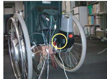
図 4.3: エンコーダの取り付け 図 4.4: エンコーダの周辺回路 図 4.5: ジャイロセンサの装着
