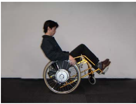
図 4.11: 前輪浮上状態で釣り合っている様子
