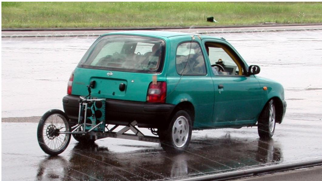
Fig 4.14: 制動試験中の実験車両“東大三月号 II”
