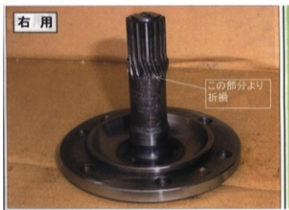
Fig A.7: モータ軸破損状況
