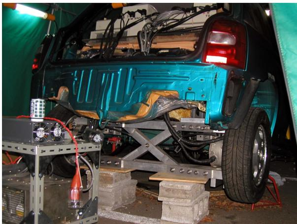
Fig 5.1: 東大三月号IIを浮上させた状態での速度制御実験風景
