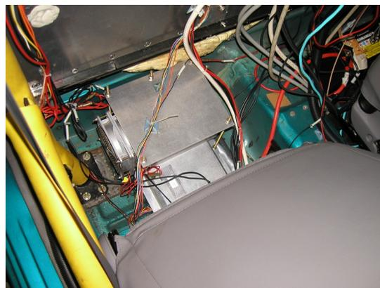
Fig A.6: DC/DC コンバータ移設後
