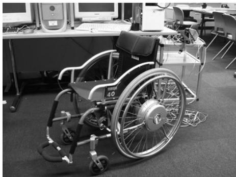
図1 福祉機器の代表的な例としてパワーアシスト車椅子 (YAMAHA JW II)
