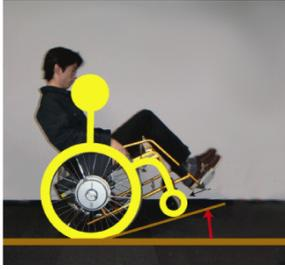
図5 前進せずにボディだけを傾けているウィリー動作
