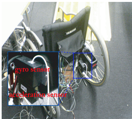
図 4.2: 加速度センサ・ジャイロセンサの取り付け
