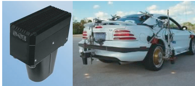
図 2.2: 車体すべり角を測定するための光学式非接触速度計
