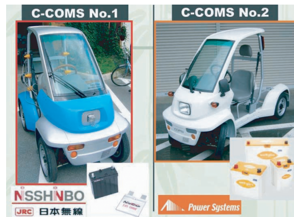
図22 キャパシタだけで駆動されるC-COMS 1 およびC-COMS 2 Fig.22 Capacitor Driven C-COMS 1 and C-COMS 2
