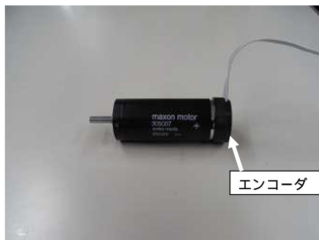
図 4-6 モータ RE30 とエンコーダ MR TypeL
