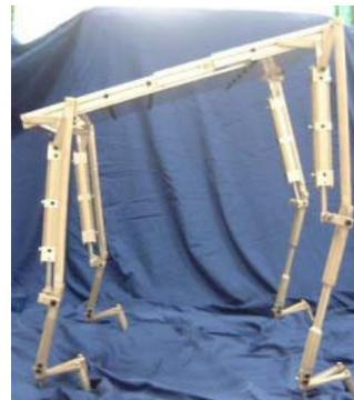
図 2.6: 災害救助ロボット Gorilla
