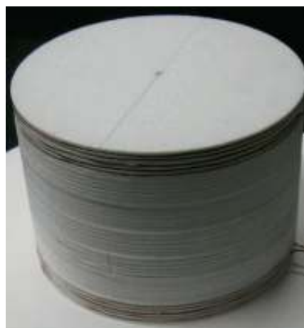
図 9 送信、受信アンテナ Fig. 9 Transmitting and receiving antennas
