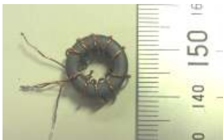
図 5 実験で使用する変成器の形状 Fig. 5 Transformer used in the experiment
