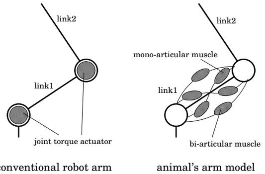
Fig.1 従来のロボットアームモデルと生物のアームモデル
