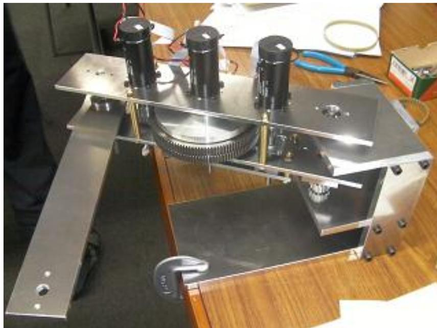
図 3.9: 遊星歯車機構を用いたロボットアーム
