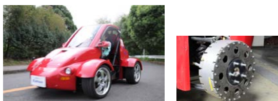
図 4.2 実験車両(FPEV2-Kanon)と搭載 IWM
