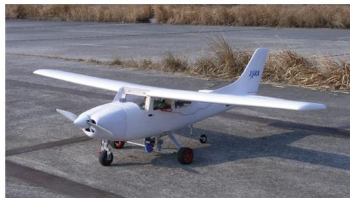
図1 JAXA 駆動輪搭載型模型飛行機
